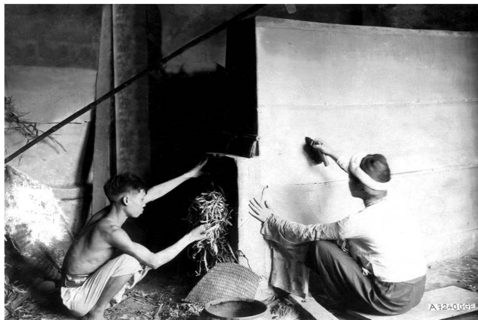
VTT 00368 - Ô 4, Application du papier sur un mur chaud pour le séchage.
