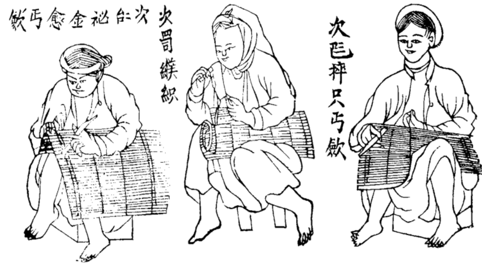
HO Pl. 390, 203, 493, Réparation de la forme pour la fabrication du papier.
