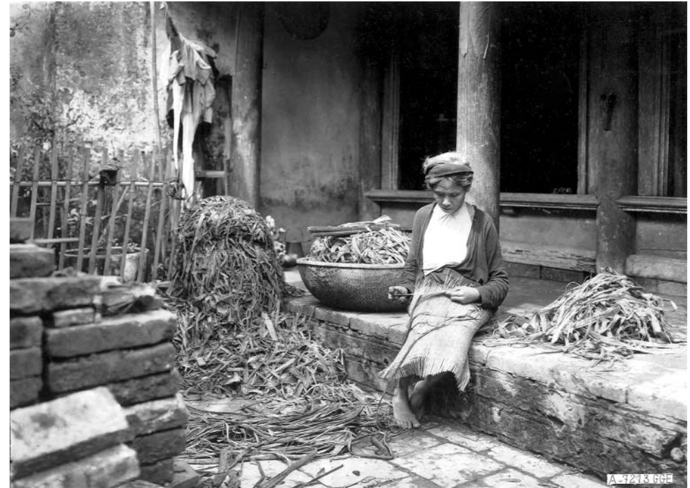
VTT 00359 - Ô 4, Écorçage du dô après la première phase de 3 jours d'immersion dans l'eau de chaux afin de produire la meilleure qualité de papier.
