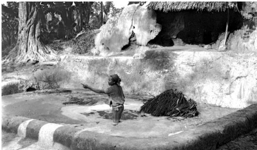
IM-IT 62-885, Rouissage des écorces dans l'eau de chaux
