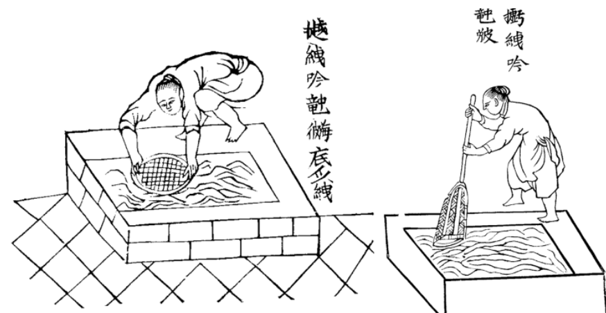
HO Pl. 287, La cuve d'immersion des lanières de mûrier pour la fabrication du papier. Pl. 388, Barattage de la cuve à immerger les lanières de mûrier.
