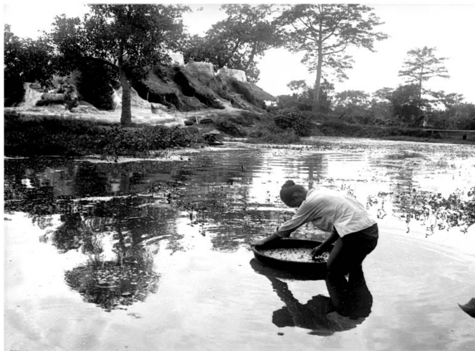
EFEO 3475, Hanoi, fabrication du papier : lavage de la pâte. IM-IT 62-888, Lavage de la pâte.
